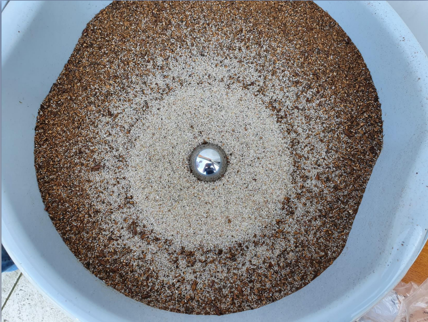
domowa symulacja tworzenia krateru (krater otoczony pokrywą materiału wyrzuconego)
